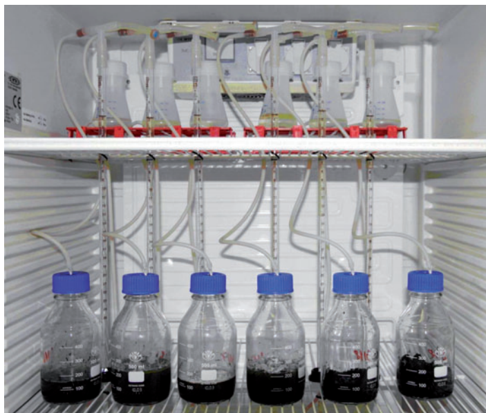
Měření produkce bioplynu v byretách
