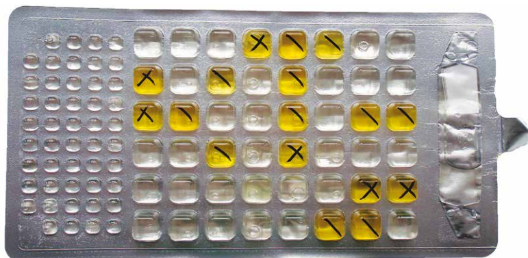
Obr. 13. Stanovení koliformních bakterií metodou Colilert Quanti-Tray
