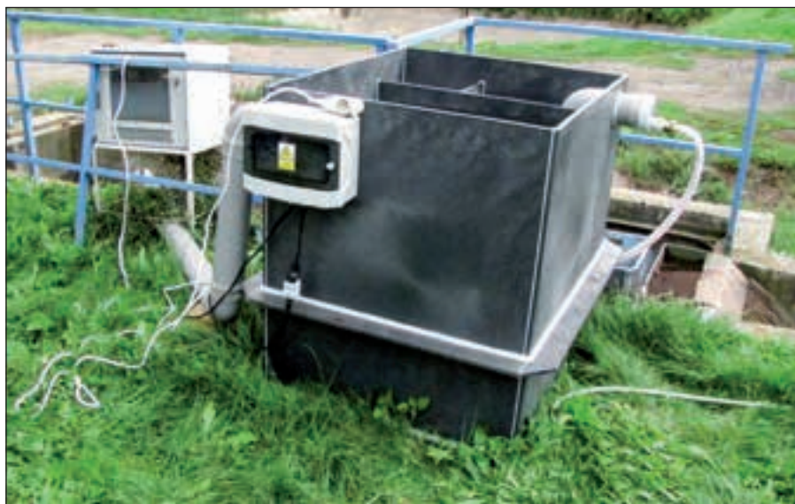
Obr. 10. Model kompaktní usazovací nádrže (foto archiv VÚV TGM, v.v.i.)
