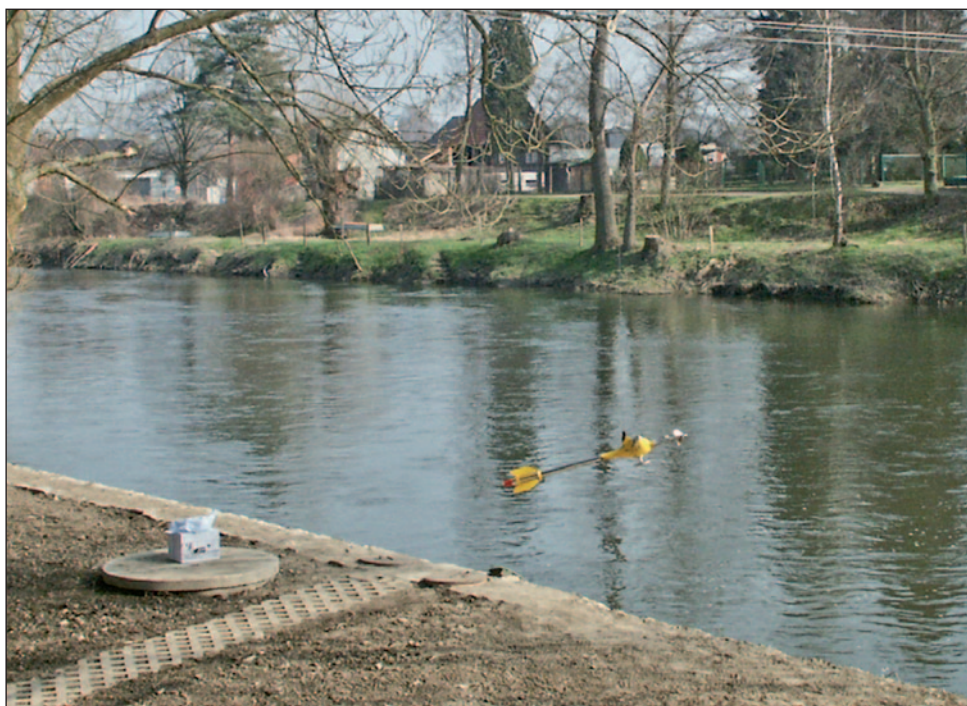
Vrtule se závažím na stabilní hydrometrické lanovce v profilu Nespeky
