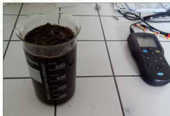
Obr. 21c. Výluh z rašelinné půdy. Vpravo konduktometr.
