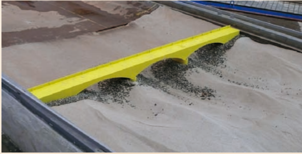
Hydraulický model klenbového mostu – výmoly po průchodu katastrofální povodně
