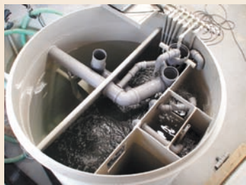
Zkoušky domovní čistírny odpadních vod
