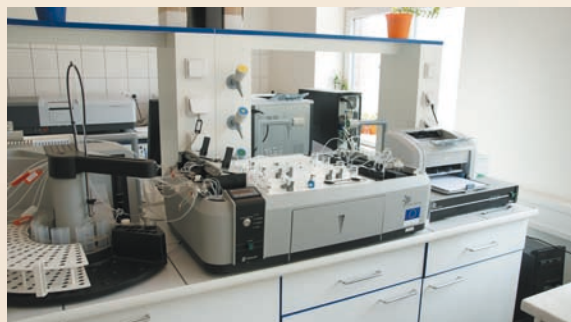
Průtokový analyzátor Skalar SANplus ke stanovení živin
