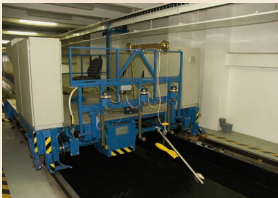
Pohled na kalibrační vozík a celkový pohled do tárovacího žlabu
