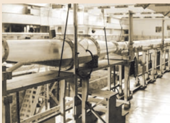
Šachtový objekt na vodním díle Želivka (vlevo), modelový výzkum šachtového přelivu a odpadní štoly na vodním díle Želivka v měřítku 1 : 35 (vpravo) a hydraulický model stolového přivaděče pitné vody z vodního díla Želivka do Prahy (vlevo)
