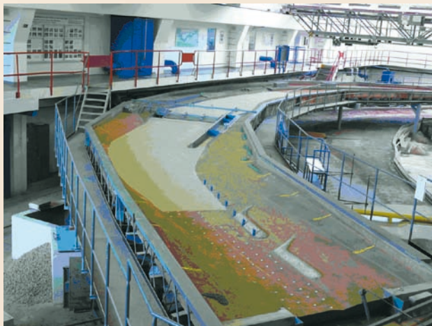
Hydraulický model vodního díla Děčín umístěný ve velké hale VÚV T.G.M., v.v.i.
