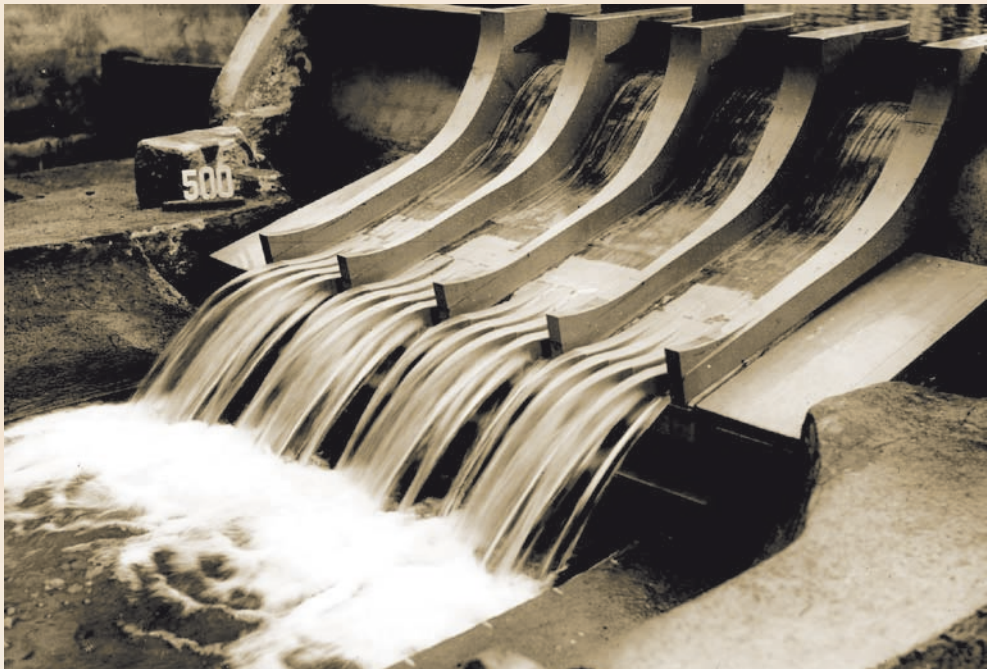
Model vodního díla Slapy vybudovaný v areálu ústavu a pohled na skutečné dílo
