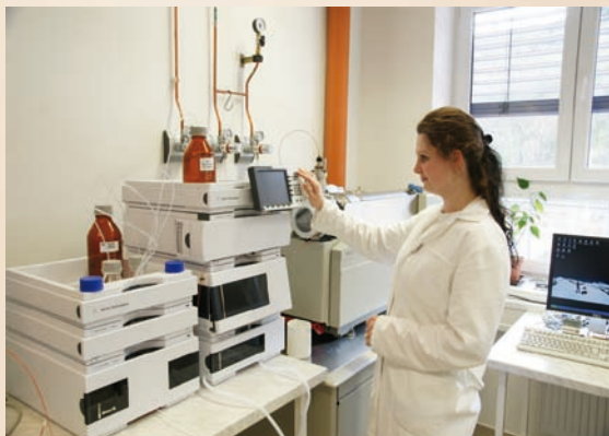
Stanovení pesticidů a farmak ve vodě metodou LC-MS/MS – celkový pohled na přístroj
