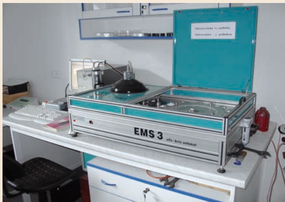
Zařízení EMS 3 alfa-beta automat pro měření velmi nízkých aktivit celkové objemové aktivity alfa a beta, objemové aktivity polonia 210 a stroncia 90
