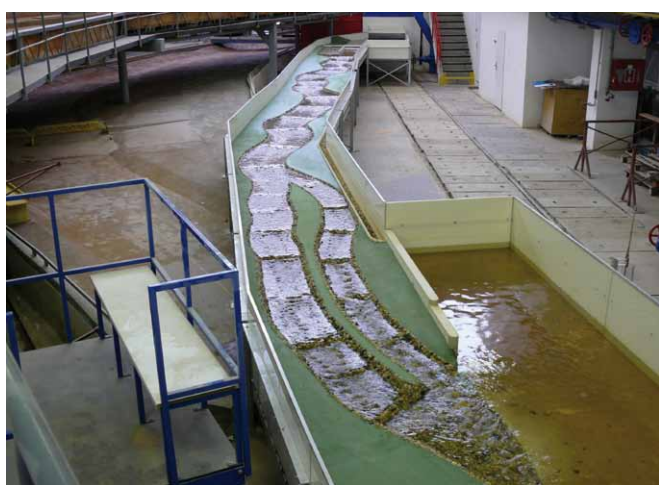
Obr. 16. Biokoridor plavebního stupně Děčín v měřítku 1 : 20 Fig. 16. Biological corridor of the Děčín weir, scaled 1 : 20
