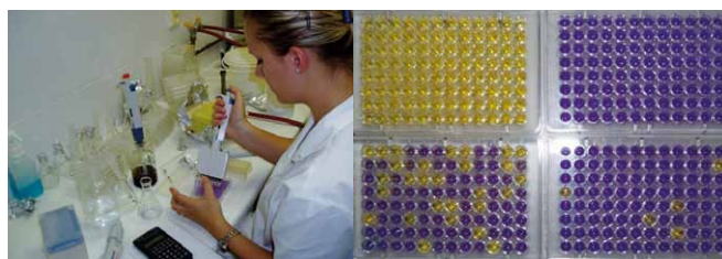
Obr. 23. Amesův fluktuální test na mikrotitračních destičkách Fig. 23. The Ames test performed using micro-titration
