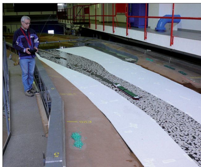
Obr. 14. Nautické zkoušky při výskytu ledových jevů Fig. 14. Nautical tests during the occurrence of ice phenomena
