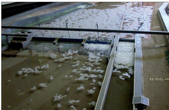
Obr. 13. Převádění ledových ker jezovým polem a plavební komorou Fig. 13. Converting of ice floes through the weir and lock chamber
