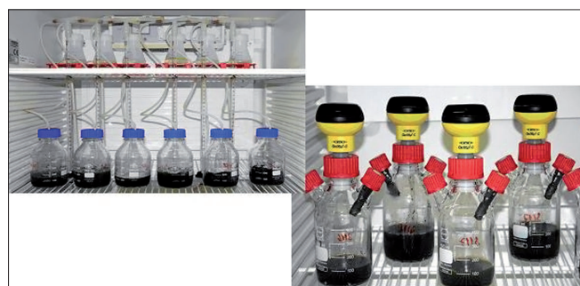
Obr. 9. Zařízení používaná na objemové měření bioplynu při anaerobních kultivacích
