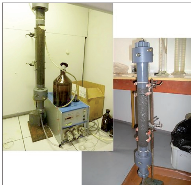
Obr. 11. Perkolační výluhová kolona Fig. 11. Percolation leach column
