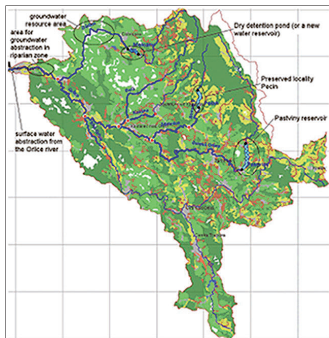
Obr. 12. Schéma říční sítě povodí Orlice sestavené v modelu HEC-ResSim – vyznačeny jsou významné vodohospodářské lokality v povodí Fig. 12. The structure of the river network of the Orlice River basin developed by HEC-ResSim model – important water management localities in the basin are marked
